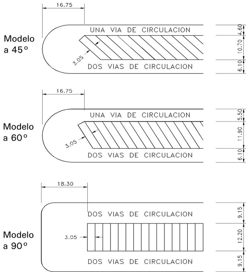
**Figura 6.24 Arreglo de Cajones para Estacionamiento**
