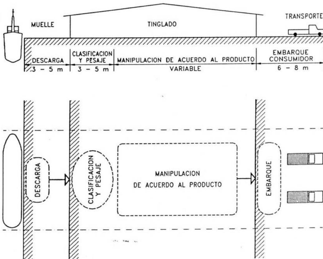
**Figura 6.5 Esquema Operativo de un Puerto Pequeño.**
