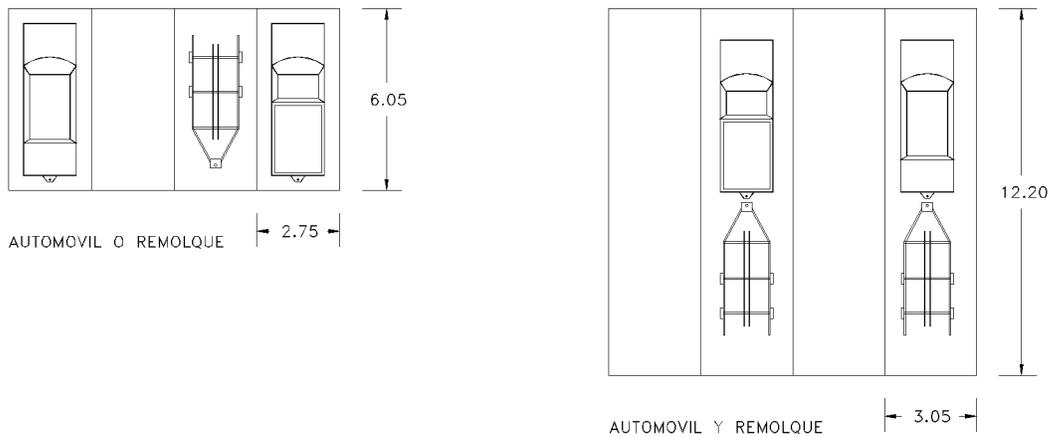
**Figura 6.25 Dimensiones Mínimas de Cajones de Estacionamiento**
