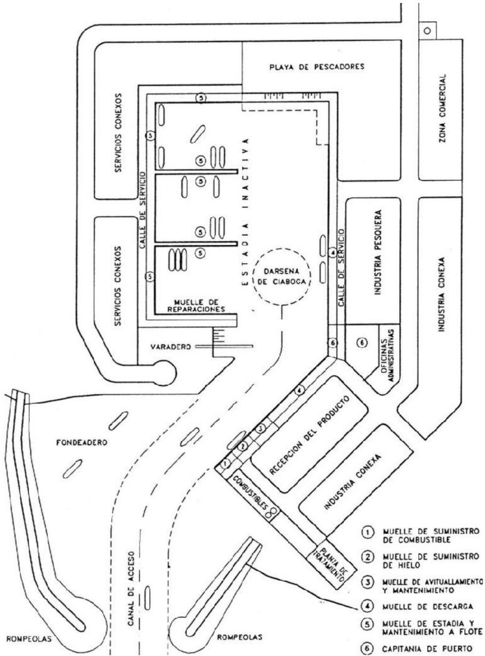
Figura 6.1 Esquema General de un Puerto Pesquero
