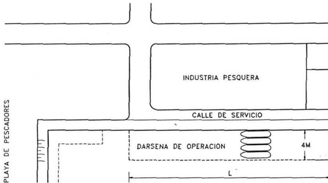
**Figura 6.4 Dimensionamiento de la Dársena de Operaciones**
